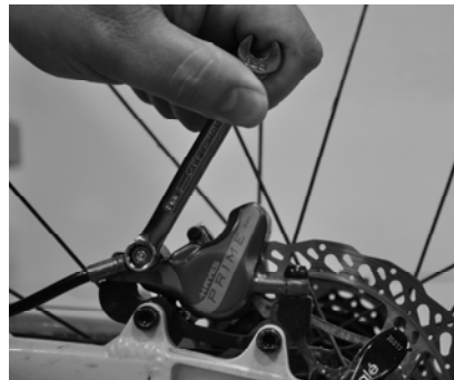
Bild 3. der Schlauchanschlussschraube zum Anpassen des Brems Schlauchs.
