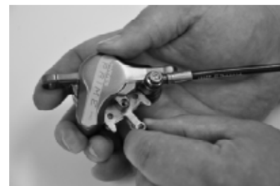
Bild 8. Entfernen der Bremsbeläge und "Sandwichfeder"
