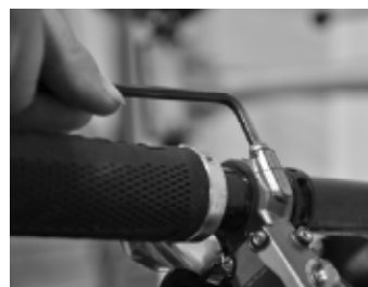
Bild 1. Ziehen Sie die obere Schraube der Griffschelle an, bis die Schelle am Geberzylindergehäuse anliegt.
