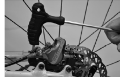
Bild 6. Montage des Bremssattels am Rahmen
