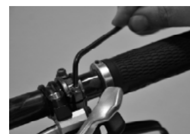
Bild 2. Anziehen der unteren Lenkerklemmschraube, achten Sie bitte auf das korrekte Drehmoment laut Tabelle
