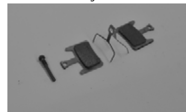
Bild 9. Bremsklötze, "sandwichfeder" und Bremsbelagsicherungsstift
