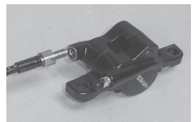
Armado de la tubería de la zapata G2
