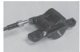
Wiedermontage des Schlauchs - G2
