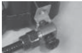
Wiedermontage des Schlauchs - G2
